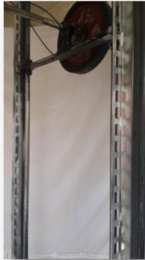
الشكل (3) السكة الحديدية ذات الثقوب المتسلسلة لتثبيت توقف الحركة (حيدر، 2023: ص9)
